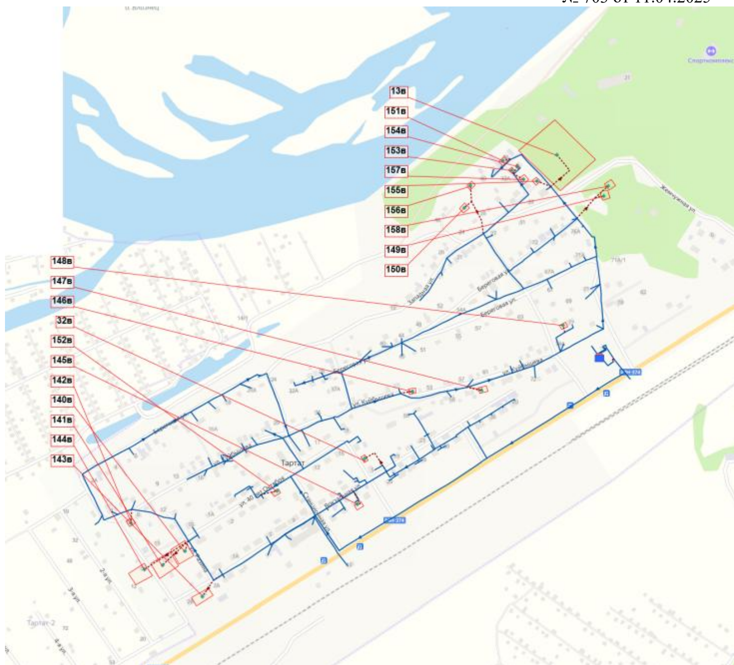
Рисунок 37. Схемы трасс сетей ВС для подключения объектов капитального строительства перспективной застройки ЗАО Железнодорожск.
